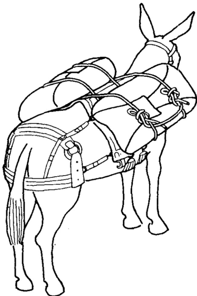
**FIGURE 24. Cross-tie sling complete.**
