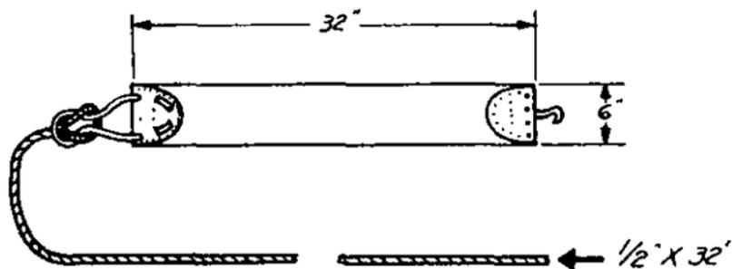
FIGURE 106. Lash-cinch (Wyoming diamond hitch).
